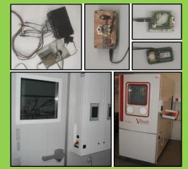
Estas pruebas pretenden forzar los sensores bajo condiciones de ambiente interior extremas, de modo que se puedan comparar en diferentes niveles, jerarquizándolos en función de las exigencias de los diferentes espacios interiores.
